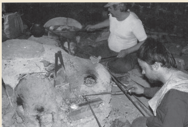
Obr. 13 – Görece Köy, Turecko. Tradičná pec na výrobu sklenených korálikov.
